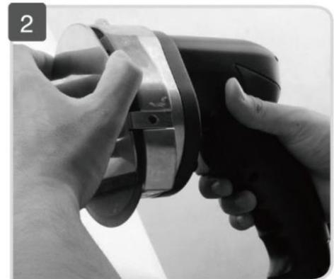
Установите защитный кожух ножа и стопорный винт.
