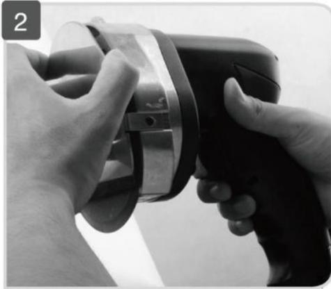
Снимите защитный кожух ножа
