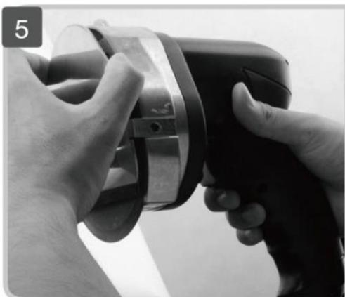
Установите защитный кожух ножа и стопорный винт.
